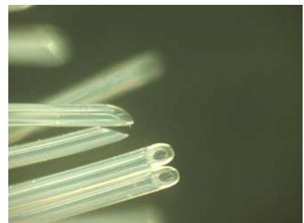
逆浸透膜の立体断面図
