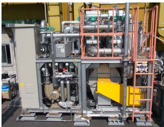
窒素循環脱着方式「K フィルター®」 VOC 回収装置（左：外観、右：模式図）
