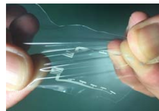
ストレッチャブル導電ペーストで作製された配線
