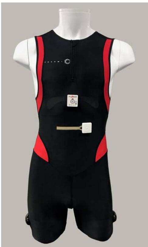
心拍、筋肉の電気信号、呼吸数が同時に計測できるコンセプトウェア
