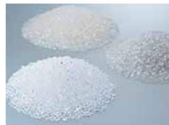
各種触媒で重合した ポリエステルレジ ン TOYOBO GS Catalyst® (前)、 アンチモン系触媒 (右)、 チタン系触媒 (後)
