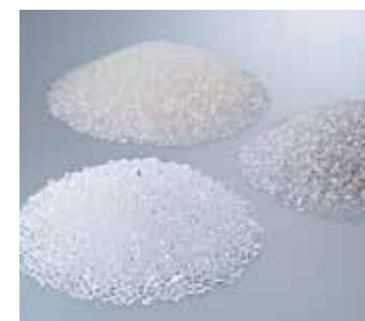
各種触媒で重合した ポリエステルレジン TOYOBO GS Catalyst®（前）、 アンチモン系触媒（右）、 チタン系触媒（後）
