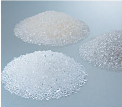
「TOYOBO GS Catalyst®」（写真手前）は他の触媒と比べ透明度が高い樹脂が合成されるという特徴がある
