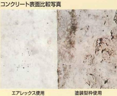
塗装型枠等の従来型枠に比べ、アバタが大幅に減少し、平滑性に優れたコンクリート表面が得られる上、型枠からの剥離作業も容易に行なえます。
