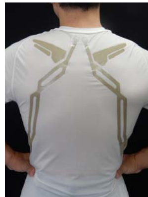
生体情報計測ウェアの電極・配線となる「COCOMI(心美)™」(黄色の部分)
