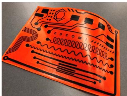
「COCOMI®」を使用した電極、配線パターンサンプル
