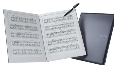
「ゼノマックス®」を使用した世界初の2画面電子ペーパー楽譜端末「GVIDO®」(GVIDO MUSIC 株式会社製)
