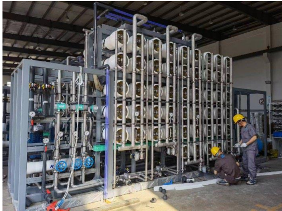
BC膜を搭載した濃縮装置 リチウム回収、排水処理など
