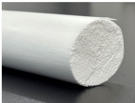
中空型ウイルス除去膜が充填された断面図
