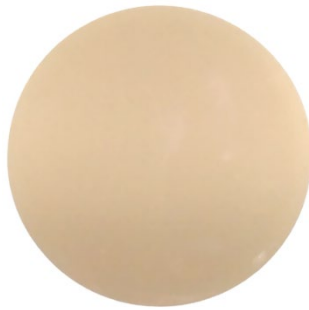
新たに開発した中分子医薬品向けの有機膜(分離膜)
