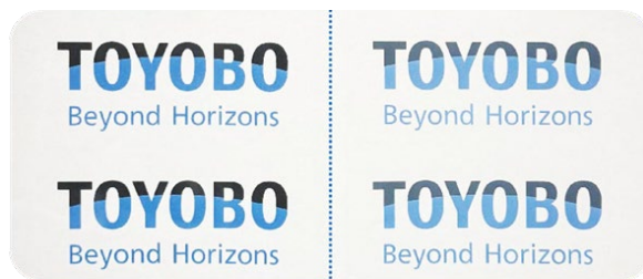
印字物の上にフィルムを置いた時の透明度の比較 (左が新開発のポリ乳酸フィルム、右が一般ポリ乳酸フィルム)
