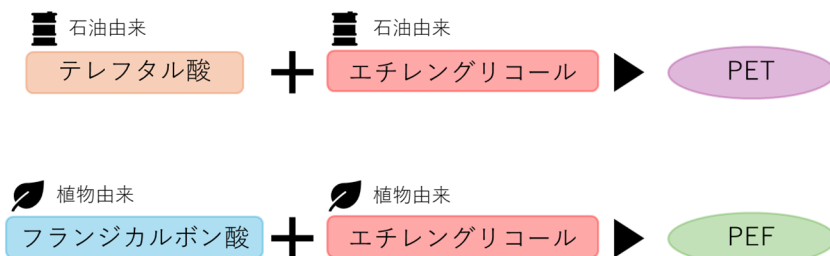
一般的なPETフィルムとPEFフィルムの原料の違い
